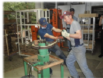
材木をU字型に加工する作業、経験30年以上のベテランです
