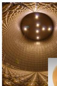
「スーパーカミオカンデ」内の大きな地下水槽には、浜松ホトニクス製の光電子増倍管が約11,200本設置されています。
