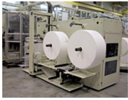
(上) 独創的な技術と機構を駆使した ZUIKOの紙おむつ製造機。
